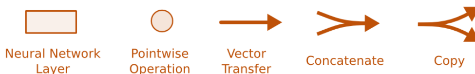
Ilustración 24: Componentes de unión de una neurona LSTM
