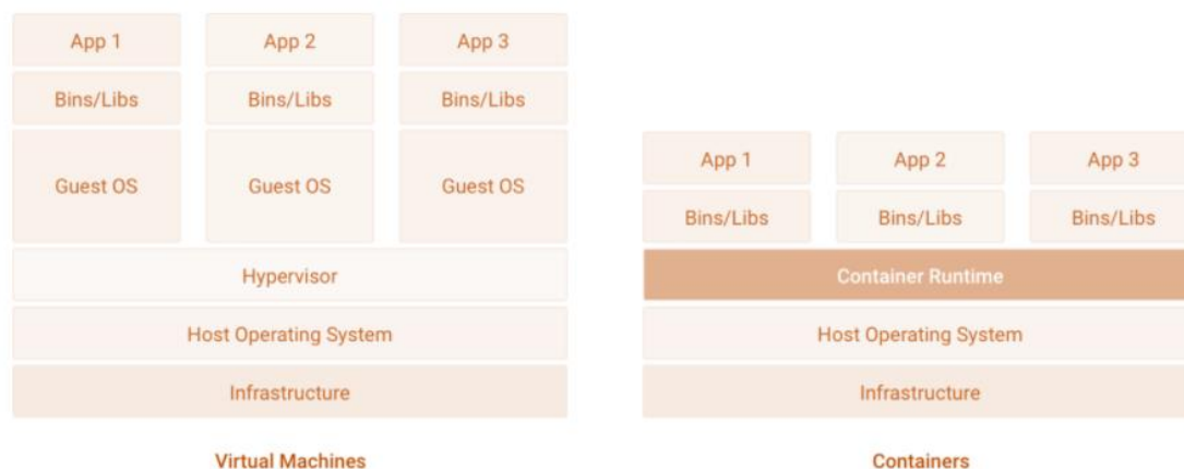
Ilustración 13: Comparación entre el funcionamiento de un contenedor Docker y una máquina virtual corriente
